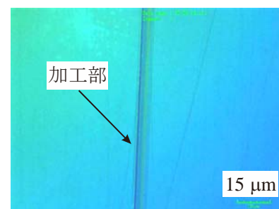
図8 製作した工具による加工痕(深さ160nm)
